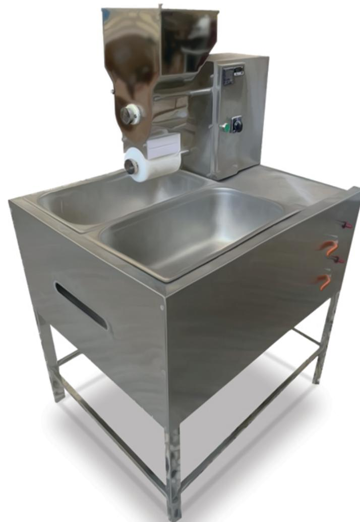
دستگاه قالبگیر پیشرفته به همراه سرخ کن های چند بنماری (دو یا بیشتر بر اساس سفارش مشتری) مناسب کسانی است که میخواهند ظرفیت بالای از تولید داشته باشند، اما به هر دلیلی نمی خواهند از سرخ کن های ریلی تمام اتوماتیک استفاده کنند. این دستگاه شامل یک قالبگیر بسیار پیشرفته است که می تواند به راحتی در طول سرخ کن حرکت کند و مناسب فست فودی ها، ساندویچی ها و کار گاه های کوچک و موکب های اربعین می باشد.
