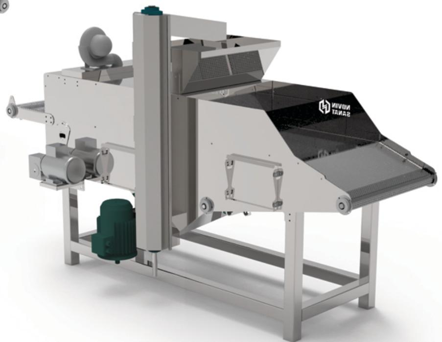
دستگاه سوخاری پاش صنعتی یکی از دستگاه های مورد نیاز در تولید صنعتی غذا های آماده دارای سوخاری (مثل ناگت، شنیسل، میگو سوخاری و ...) میباشد. کار این دستگاه این است که محصولاتی را که روی آنها سس پاشیده شده را به یک لایه سوخاری آغشته کند. محصولات بعد از این دستگاه وارد دستگاه سرخ کن میشوند.
