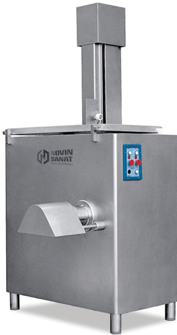
دستگاه چرخگوشت - میکسر صنعتی با قابلیت چرخ کردن و میکس کردن همزمان مواد فلافل، ناگت، کتلت و ... مورد استفاده کارخانجات تولید مواد غذایی است. در این سیستم مواد در ابتدا، کاملاً چرخ می شود و سپس مخلوط میگردد که این فرآیند باعث همگنی و یکنواختی مواد می گردد.
